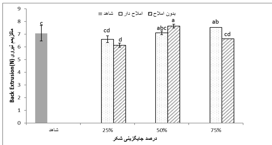
شکل ۵ - تاثیر جایگزینی نسبی شکر با ۳ سطح از دو نوع پرمیت هیدرولیز شده با و بدون املاح بر بیشینه نیروی back extrusion
