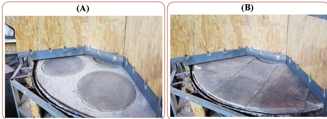
شکل ۳- A: صفحات سفالی دایره‌ای شکل و B: صفحات کوردیریت - مولایت پس از نصب در روی ماشین
