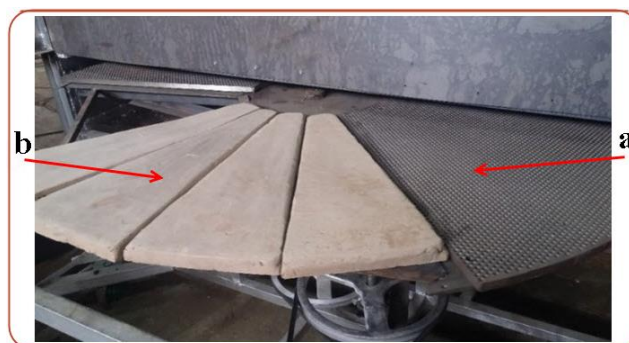
شکل ۲- قطاع‌های a: چدنی و b: سفالی دوزنقه‌ای شکل Figure 2- Circular sectors of a: cast iron and b: trapezoidal earthenware
