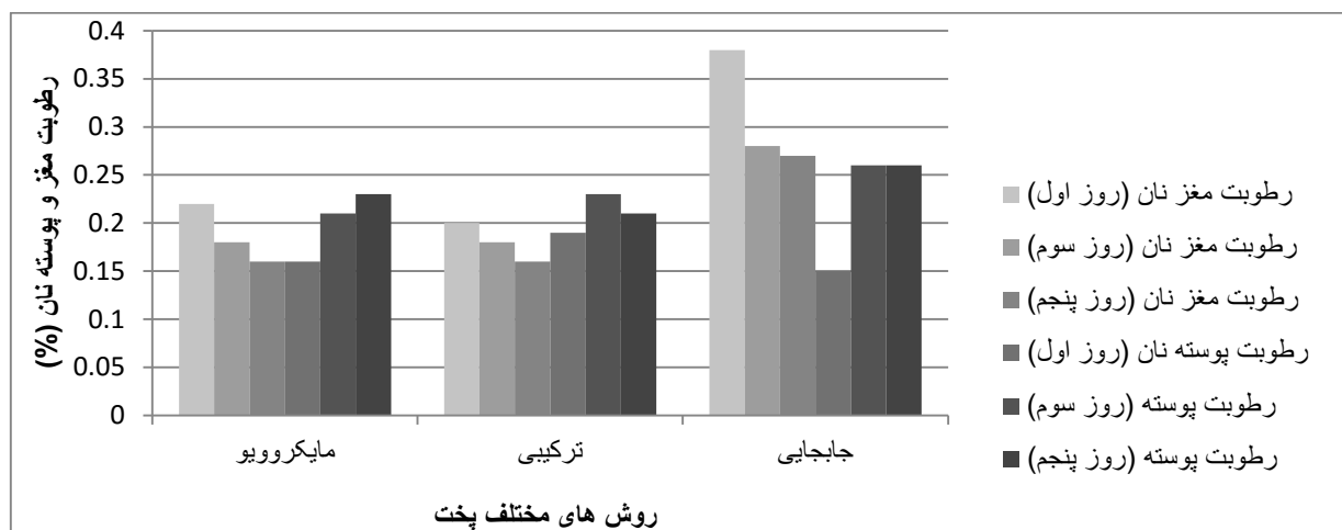
شکل ۴- رطوبت مغز و پوسته نان های پخته شده در آون های مختلف در طول نگهداری
