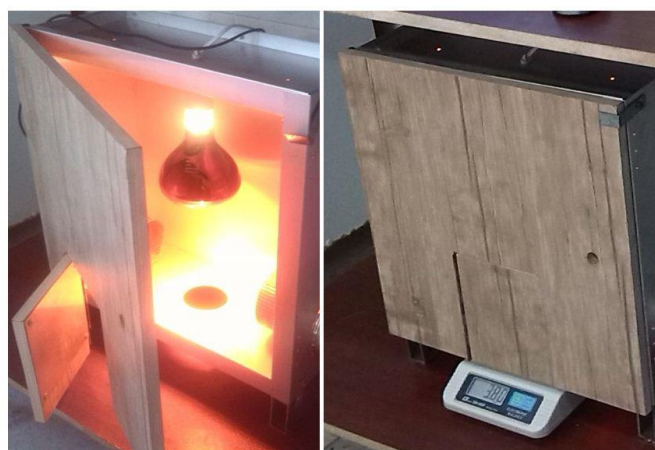
شکل ۱- خشک‌کن مادون‌قرمز مورد استفاده در این تحقیق
