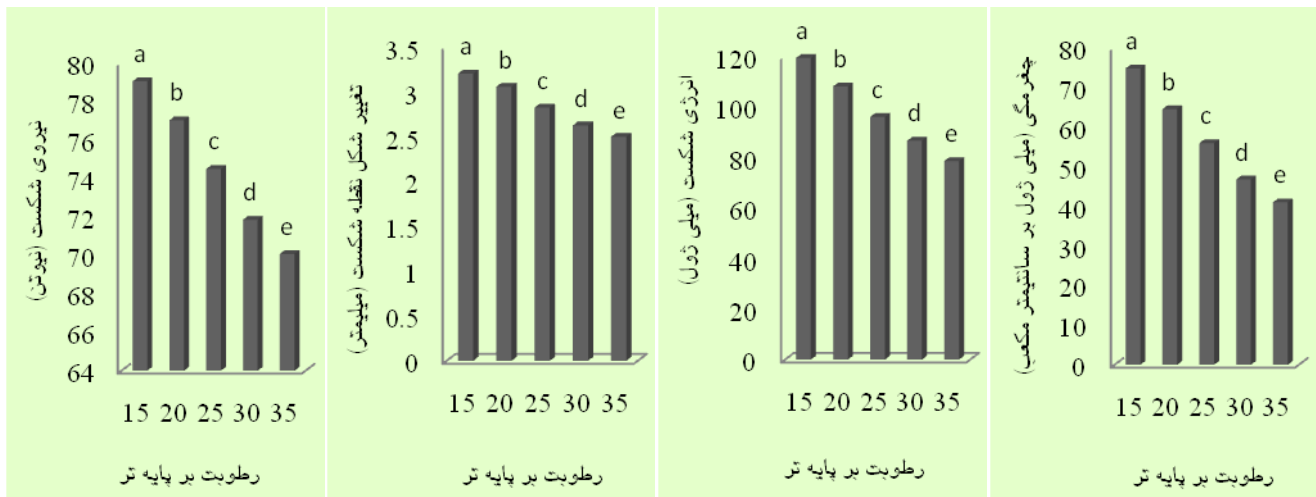
شکل ۴- تأثیر رطوبت بر خواص مکانیکی سه رقم پسته
